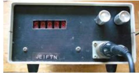
やっと周波数測定の準備が出来たのでHF機の7MHzバンドの下から上まで50kHz置きに送信周波数を測定してみましたら、+68Hzから+80Hzずれていると表示されました。
