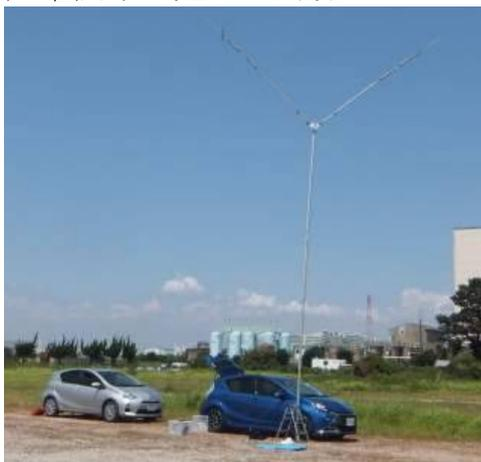
公開運用の場合、ゲストオペレータに快適に運用を楽しんでいただける為でなく、一般の方にも最高のコンディションでの運用面を見てもらうようアンテナやリグの準備を万全にしなくてはならず、今回の運用に先立って開催1週間前に千葉港近くの広い駐車場で JA2SWH 佐竹さんと二人で4バンドV型ダイポールを実際の運用の形で組立て調整を実施しました。
