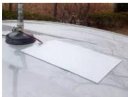
マグネット基台にOUTBACER アンテナ 1cmで約20kHz 変化する アースはマグネットアース板
