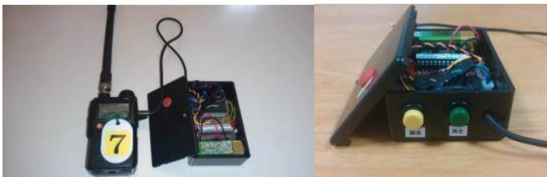
FOX ID発信機は、今回もJL1CML木村さん自作の録音音声自動間欠発信装置を使い、49秒間音声によるID送出+11秒間停止=合計60秒間で1サイクルとなる繰り返しを行いました。製作した装置は、写真のとおり、APR9600音声録再生デバイスICとArduinoマイコンのプログラマブル間欠送信/受信切替のデバイスをプラスチックケースにコンパクトに収めたもので、赤色に見えるマイクとケース上部のボタンSW2個を使い肉声を録音することができます。送信/休止間隔は基盤上に設けられたシリアルINFを通じてパソコンで設定することができ、電源は006P9V電池1個で動作という、毎回ながらJL1CML局の力作です。なお、今回の装置は、コンテスト用のCQマシーンとしての活用も十分可能です。
