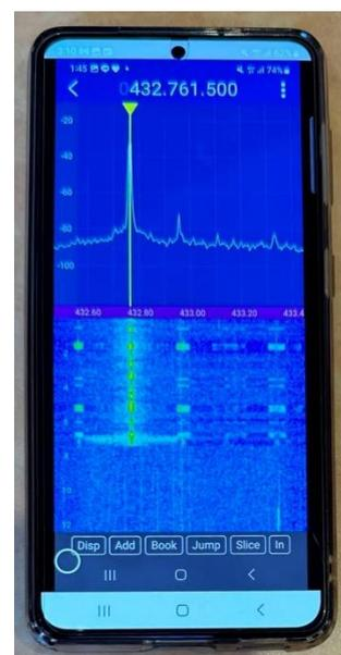
アンテナ自体は通常の指向性アンテナの使用なのですが、受信機はアマチュア無線機ではなく、USB dongle とスマホアプリ MagicSDR を利用した SDR での参加です。
